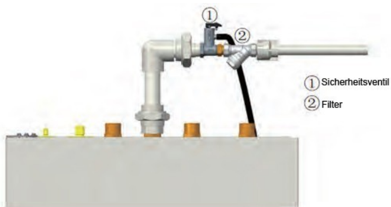
Installationsmodus 1 des Leitungswassersicherheitsventils (Eingangswasserdruck = 0,1 ~ 0,5 Mpa)
